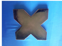
Şekil 39: Yıldız ara geççeye sır içi mangan moru uygulama Figure 39: Glaze inside application of manganese purple to the star shaped transition fit
