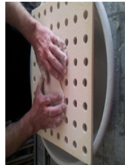
Şekil 12: Kuruyan alt yapının tesviyesi Figure 12: Leveling dry sub-structure
