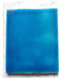
(900 derece alkali sır +%2 cuo2) Şekil 21: Turkvaz çift pişirim. Figure 21: Turquoise double firing.
