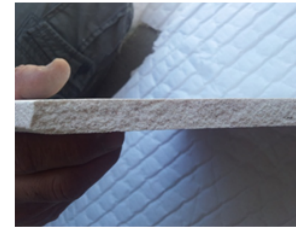
Şekil 13: Bisküvinin kırık kesiti Figure 13: Broken section of the biscuit
