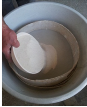
Şekil 2: Kuvarsın Elenmesi(İstenilen tane iriliğine ulaşma)
