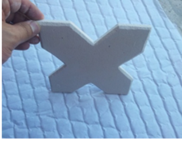
Şekil 14: Yıldız çinilerin ara geçmeleri büskivisi Figure 14: Transition fit biscuits of star tiles
