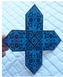
Şekil 38: Sır altı Dekorlu sır içi renklendirmeli saf bakır oksit turkuvaz Figure 38: Decorated underneath the glaze,colored inside the glaze, pure copper oxide turquoise
